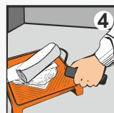
Нанесите краску на поверхность кистью, валиком или распылением в два слоя с промежуточной сушкой не менее 2 часов. Через 24 часа после нанесения последнего слоя возможна эксплуатация покрытия в щадящем режиме, через 14 дней покрытие приобретает окончательную прочность.
